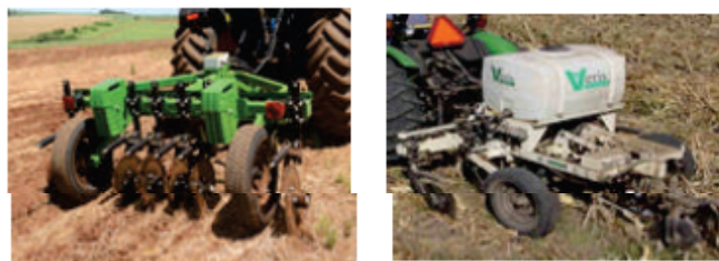
Figura 1 – Condutivímetro tratorizado – Veris (a) e sensor de condutividade elétrica e pH do solo (b). Fonte: Stara (a) e Veris Technologies (b).
