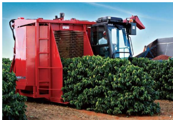
Figura 9 – Colhedora automotriz Case Coffee Express 200. Fonte: Case Agriculture (2018).
