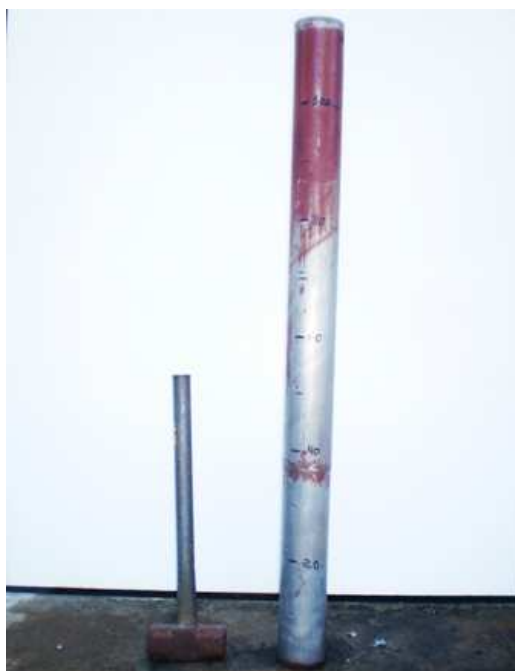
Figura 6. Tubo de aço galvanizado e marreta de ferro, utilizados para a retirada de solo e coleta de raízes de piaçaveiras.
