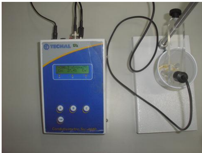
Figura 4. Mensuração da condutividade elétrica de sementes de Capsicum sp..
